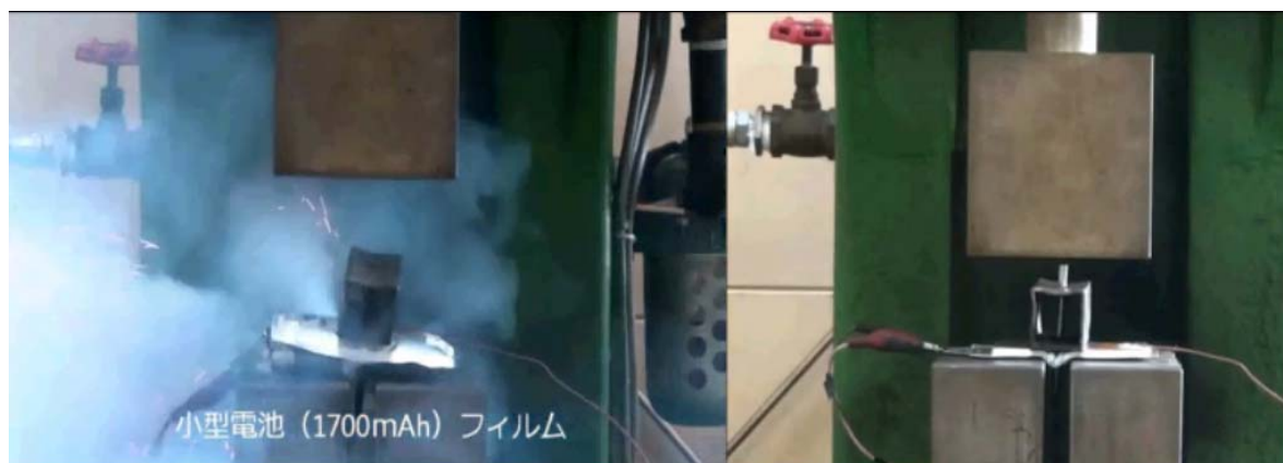
比較品（塗布型微多孔膜、左側の写真）と当社品 NanoBaseX（右側の写真）
