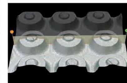
セラミックの2段ピンドット加工
